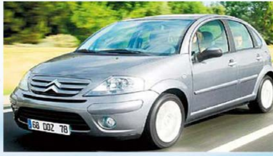
La C3 de 2008 (diesel) : 1.400 cm 3 de cylindrée, 70 CV de puissance, 160 km/h, 1.000 kg
