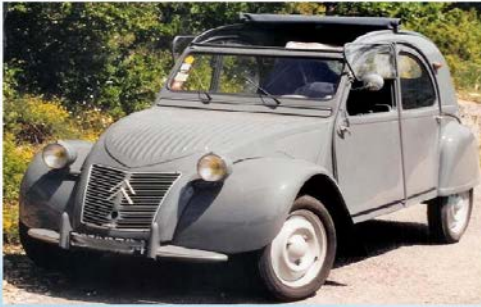
La 2CV de 1950 : 375 cm 3 de cylindrée, 9 CV de puissance, 60 km/h, 500 kg
